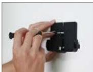
Regolare la posizione della base di montaggio e stringere le viti.
